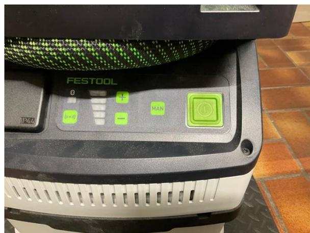
4. Steuerung der Saugleistung kann über die „+“ und „-“ Tasten geregelt werden.
