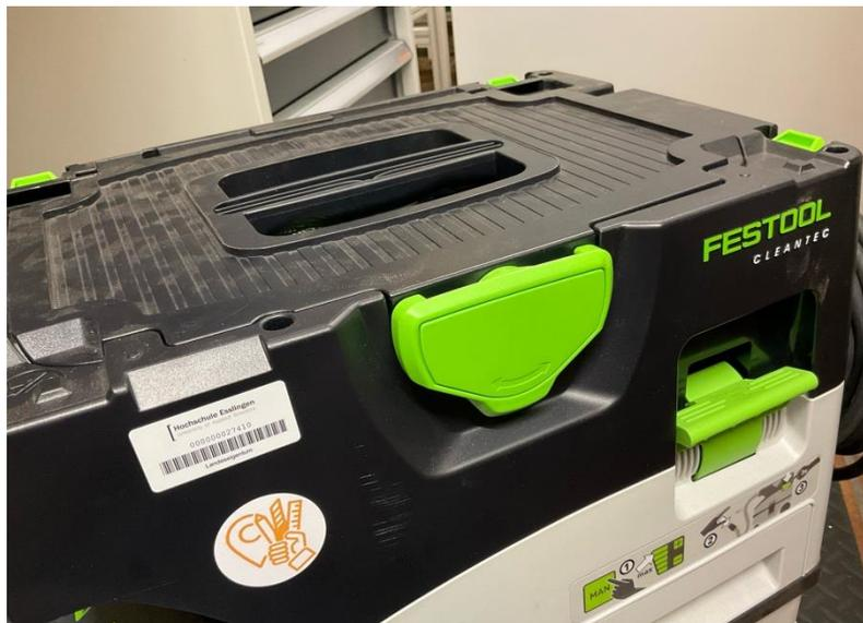
3. Einschalten: Einschaltknopf vorne am Gerät betätigen, danach den „MAN“ Knopf drücken -> Wechsel in den manuellen Modus.
