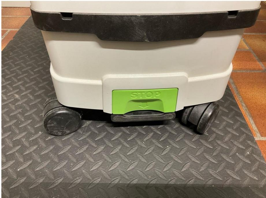
6. Sollte sich der Sauger irgendwo festsaugen, kann an der rechten Seite des Gerätes der Grüne Hebel betätigt werden, welcher das Ventil des Saugers öffnet:
