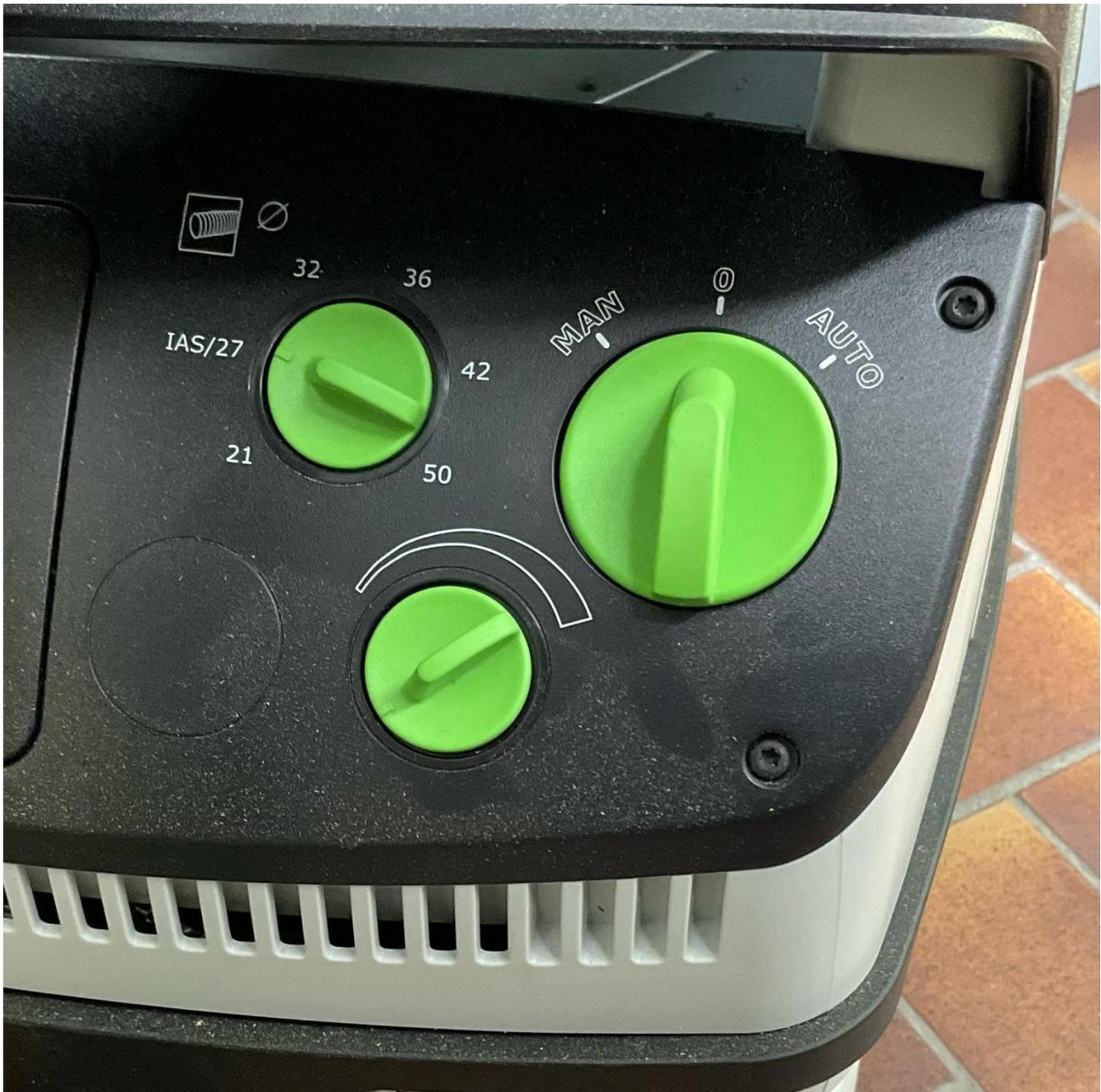
4. Steuerung der Saugleistung kann über den unteren Regler stufenlos eingestellt werden.
