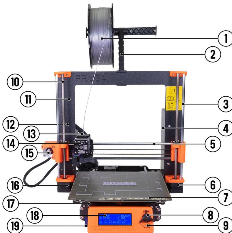
*Bild 1 - Original Prusa i3 MK3S+ Druckerbeschreibung: (1) Filament-Spule; (2) Spulenhalter; (3) Z-Achse; (4) Stromversorgung; (5) X-Achse; (6) Z2-Schrittmotor; (7) Heizbett mit Federstahlblech; (8) LCD-Knopf; (9) Reset-Knopf; (10) Gewindespindel; (11) Druckerrahmen; (12) USB-Anschluss; (13) Einsy Rambo Board; (14) Extruder Schrittmotor; (15) X-Schrittmotor; (16) Z1-Schrittmotor; (17) Y-Achse; (18) LCD-Anzeige; (19) SD-Kartensteckplatz*
