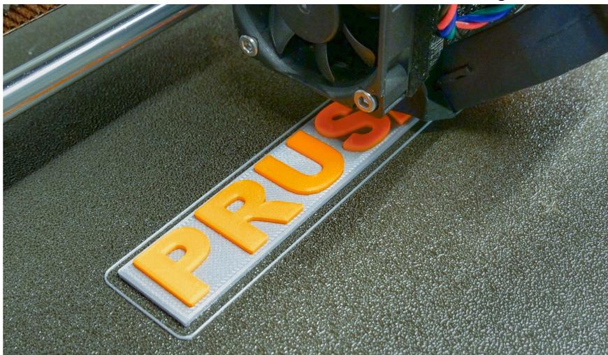
Bild 34 - Mehrfarbiges Objekt, das mit ColorPrint gedruckt wurde
