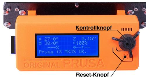
Bild 15 - LCD-Anzeige und Kontrollknöpfe
