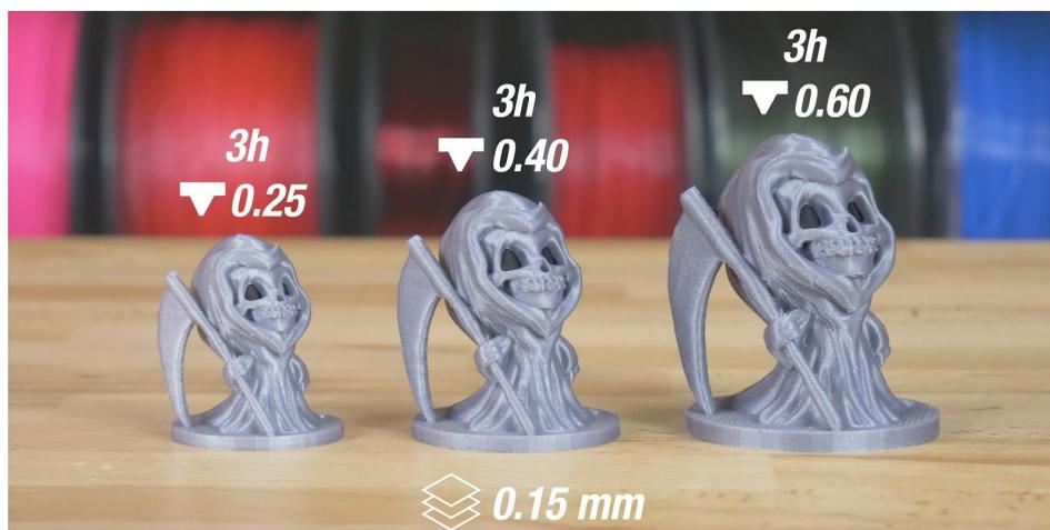
Bild 22 - Unterschiedliche Düsengrößen haben einen großen Einfluss auf die Druckgeschwindigkeit
