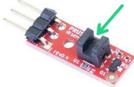
*Bild 39 - IR-Filamentsensor*
