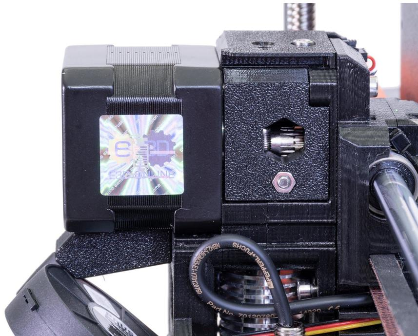
*Bild 40 - Reinigen des Extruders - hier sehen Sie die Antriebsritzeln durch das Wartungsloch*
