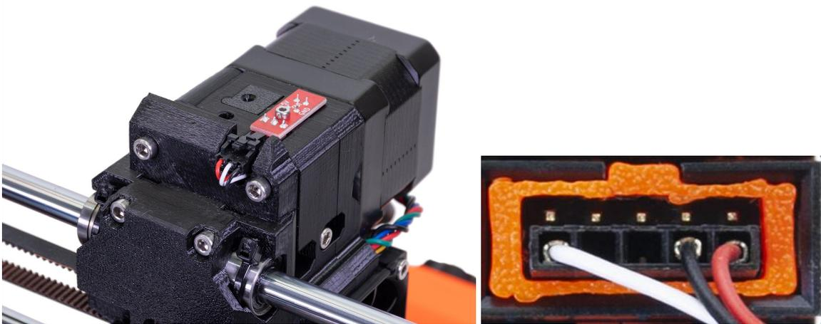
*Bild 38 - Korrekt angeschlossener und sitzender Filamentsensor*
