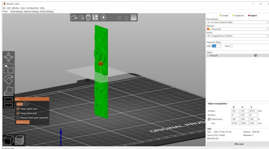
Bild 33 - Schneiden des Objekts mit der Option Schnitt
