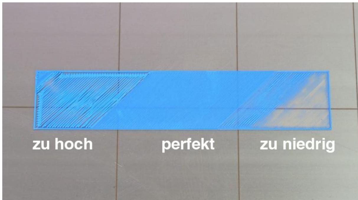
Bild 11 - Die richtig abgestimmte erste Schicht
