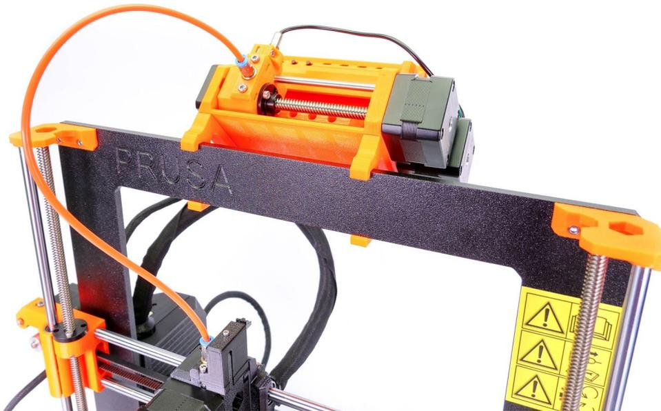
*Bild 23 - Multi Material Upgrade 2S auf dem Original Prusa i3 MK3S+ installiert*
