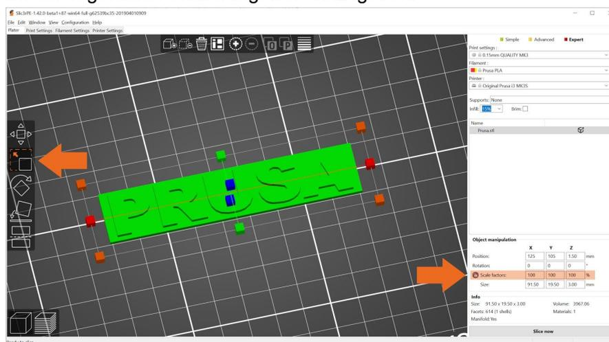
Bild 32 - Ändern des Maßstabs eines gedruckten Objekts
