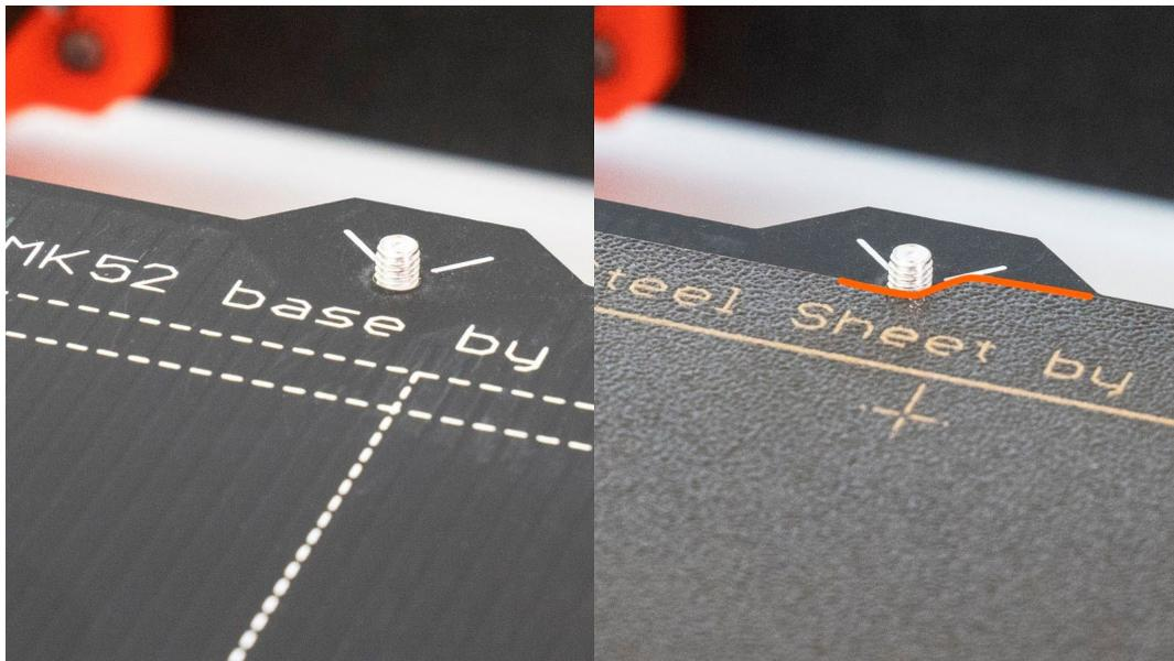
*Bild 5 - Heizbett des MK52 mit pulverbeschichteter Federstahlplatte*
