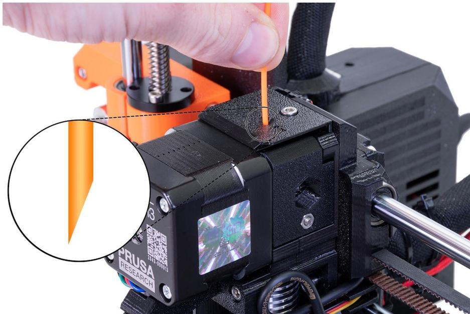
*Bild 9 - Einlegen des Filaments in den Extruder*
