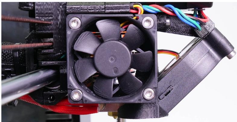
Bild 36 - Lüfter zur Düsenkühlung
