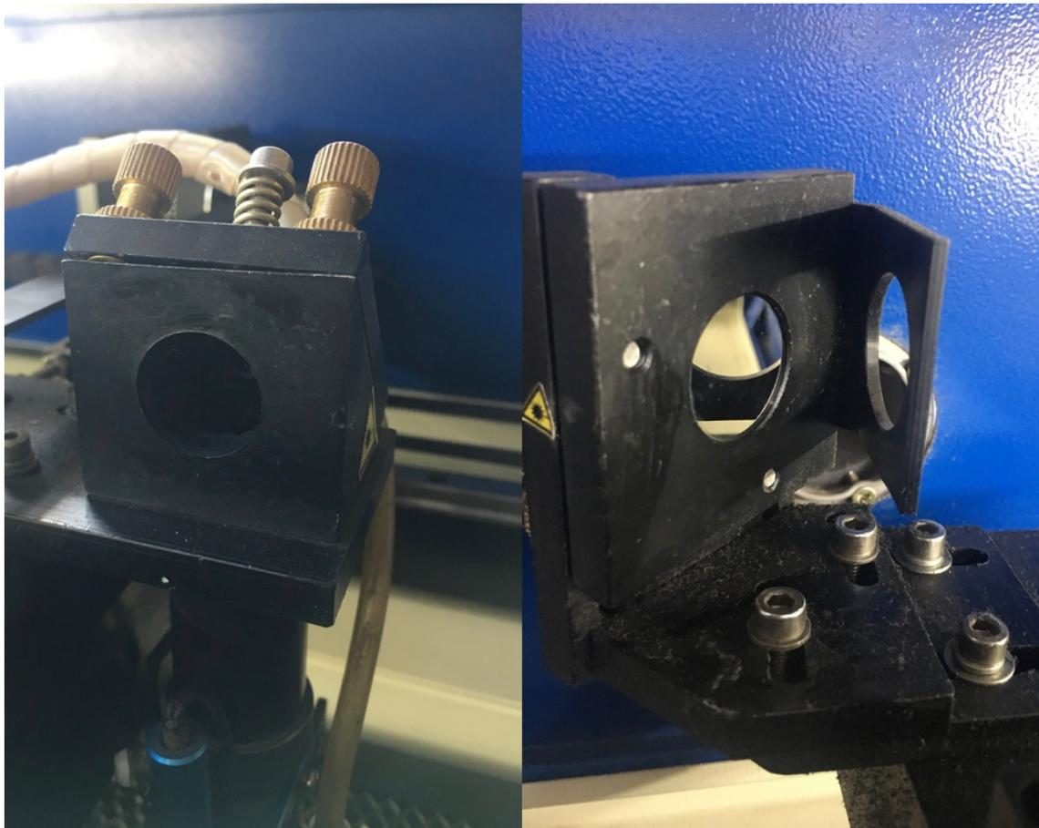
Zur Reinigung der Spiegel (siehe Abbildung 2) darf nur Isopropanol und Q-Tip verwendet werden. Dies sollte mindestens einmal im Monat durchgeführt werden, um eine konstante Leistung des Lasers zu garantieren.
