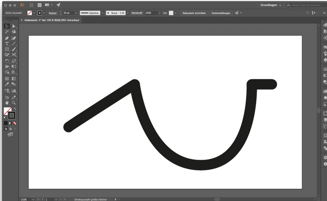
Was in Abbildung 15 zu sehen ist, entspricht dem, was von dem Laserkopf nachgefahren würde. Die Abbildung zeigt die Pfadansicht. Um zwischen GPU-Vorschau und Pfadansicht zu wechseln kann die Tastenkombination Command Y (macOS) oder Strg Y (Win) genutzt werden.<sup>14</sup>
