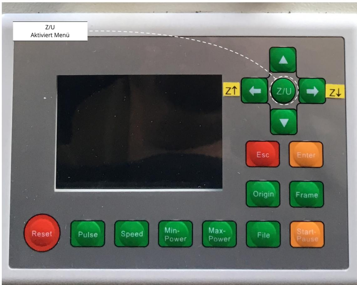
Abbildung 11: Die Steuerung der Z-Achse
