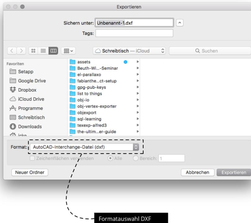
DXF Dateien können aus AI unter Datei>Exportieren>Exportieren als... ausgegeben werden. Dazu muss am unteren Rand des Datei Dialogs die Option AutoCAD-Interchange-Format (DXF) gewählt werden. Siehe [Abbildung 20](#).
