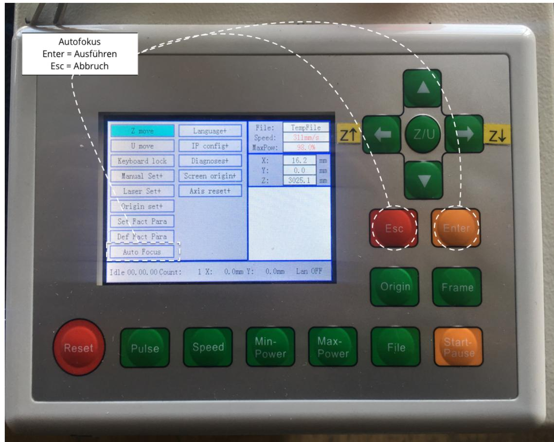
Um den Laserkopf in seiner Distanz zur Oberfläche des Materials einzustellen, hat die Maschine eine Autofokus Funktion. Dazu wird der Distanztaster<sup>9</sup> (siehe Abbildung 8) mit dem Steuerkreuz in die Mitte des Materials gefahren.
