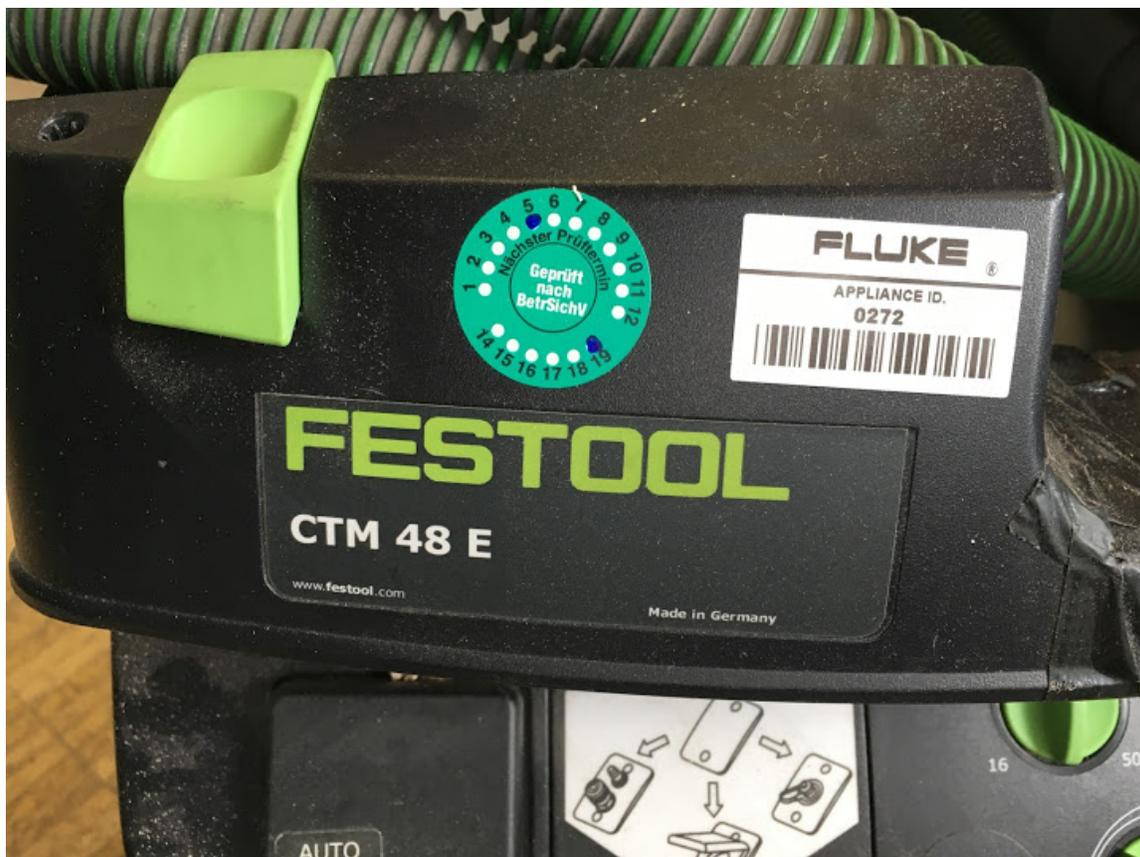
Der Arbeitsraum und auch die unteren Bereiche der Anlage müssen regelmäßig gereinigt werden. Für eine oberflächliche Reinigung kann das „Festo CTM 48 E Saugmobil“ der Modellbauwerkstatt genutzt werden, um die Anlage auszusaugen (siehe Abbildung 3). Es sollte jedoch auch regelmäßig mit einem Lappen eine tiefer gehende Reinigung vorgenommen werden. Auch unterhalb des Gitters und der Lamellen sowie im unteren Raum des Lasers.<sup>3</sup>
